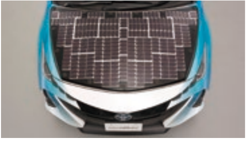
トヨタが「プリウス PHV」のルーフやフード、バックドアなどに太陽光発電パネルを搭載し、公道走行用実証車を製作
